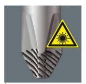
À l"aide d"un laser extrêmement concentré, on génère structure superficielle acérée. La dureté des stries réalisés par ce procédé atteint jusqu"à 1000 HV 0,3. Wera Lasertip s"agrippe dans la tête de vis et empêche le dérapage hors de celle-ci. Pour vis à fente, Phillips et Pozidriv.
