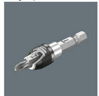
Pour une jonction ferme, non vacillante entre le support et l'embout. Découplage très rapide : il suffit de faire coulisser la douille vers l'avant et de changer l'embout. En version magnétique pour un positionnement plus facile des vis.
