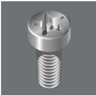
Un profil TORX PLUS® à cinq flancs et perforation. Géométriquement parlant, cette pointe comporte un flanc de moins et a été pourvue d'une perforation destinée à empêcher le desserrage non autorisé des vis de sécurité. Ces dernières ne peuvent pas être actionnées avec les outils usuels disponibles dans le commerce.
