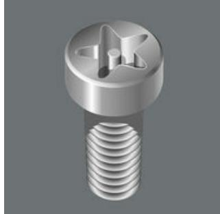
Un profil TORX PLUS® à cinq flancs et perforation. Géométriquement parlant, cette pointe comporte un flanc de moins et a été pourvue d'une perforation destinée à empêcher le desserrage non autorisé des vis de sécurité. Ces dernières ne peuvent pas être actionnées avec les outils usuels disponibles dans le commerce.
