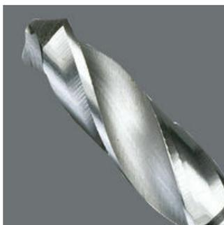
Mèche hélicoïdale - pour applications bois • emmanchement 1/4" convenant pour porte-embouts répondant à la norme DIN 3126-D 6,3 (ISO 1173) • très bonne transmission de puissance grâce à la queue hexagonale • acier rapide haut rendement HSS • élasticité adaptée du matériau, pour une longévité accrue • très bonne précision de concentricité • embouts à finition extra-rigide pour une durée de vie particulièrement longue
