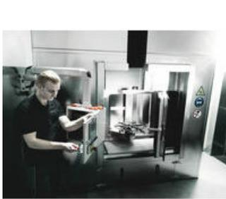
Le contrôle unitaire sous 10 000 volts conformément à la norme IEC 60900 garantit un travail en toute sécurité jusqu'à 1 000 volts.
