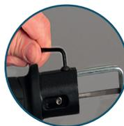
La scie est livrée de série avec un guide lame réglable en longueur. Pour le régler, il suffit de desserrer la vis au dessus de la tête de la scie à l'aide de la clé hex. fournie, régler la longueur du guide et resserrer la vis.
