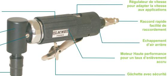
Niveau sonore 78 dB(A) - Vibrations 0,7 m/s<sup>2</sup> - Entrée d'air 1/4" PT
