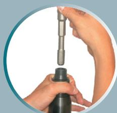
L'emmanchement hexagonal évite la rotation du burin dans le cylindre. Il permet une parfaite maîtrise des mouvements de l'outil, une plus grande précision de travail. Il permet de travailler avec plus de sécurité.
