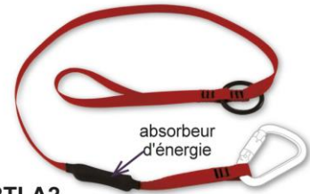
Code RTLA2 Longe avec absorbeur à 1 boucle d'étranglement et anneau métallique rond pour accrochage de l'outil à la ceinture + boucle cousue "côté harnais"
