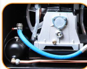
Cuve tampon de 2 litres Permet de refroidir l'air en sortie du compresseur.
