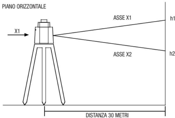
Posizionare apparecchio a circa 30 m da un muro come nel disegno sopra. Posizionare l'unità con l'asse X1 diretto verso la parete.
