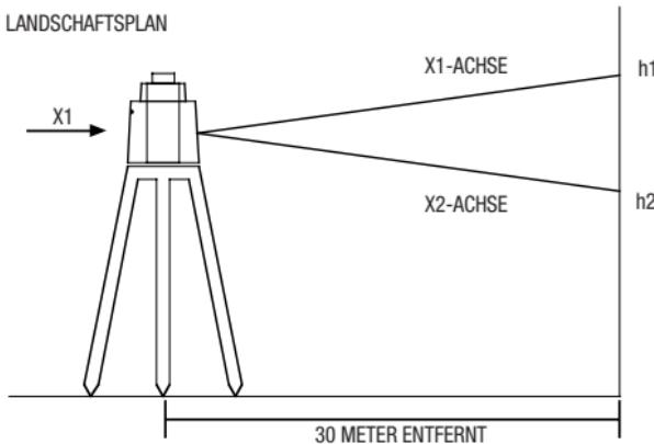
Stellen Sie das Gerät etwa 30 m von einer Wand entfernt auf, wie in der Zeichnung oben gezeigt. Positionieren Sie das Gerät mit der X1-Achse zur Wand hin.
