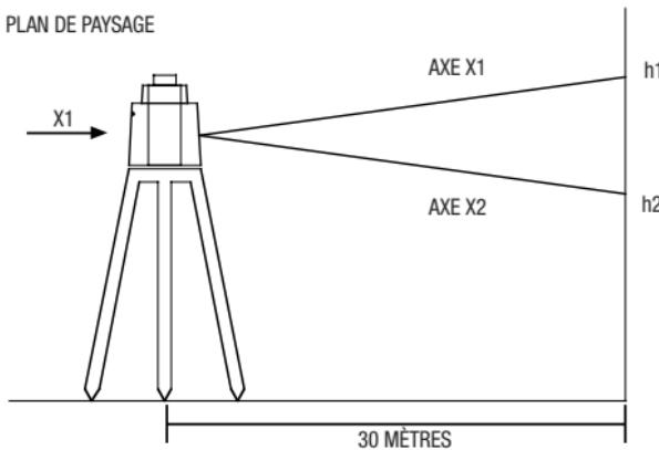
Placez l'appareil à environ 30 m d'un mur comme indiqué sur le dessin ci-dessus. Positionnez l'unité avec l'axe X1 dirigé vers le mur.
