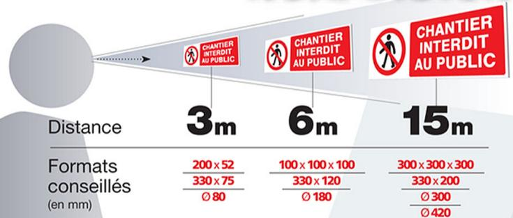
Les panneaux doivent être à une hauteur et selon une position appropriée par rapport à l'angle de vue.
