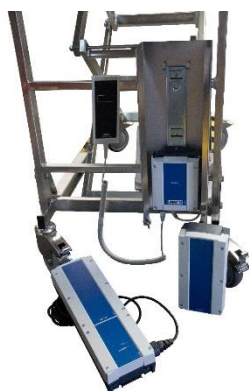
2 batteries 24 VCC + 1 chargeur autonome
