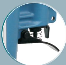
L'agrafeuse est munie d'une sécurité à la gâchette, une simple rotation de cette sécurité pour la mettre dans l'axe de la gâchette empêche tout actionnement de l'outil.
