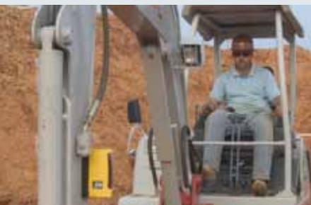
Grâce aux solutions de guidage laser visuel Spectra Precision® Laser, vous passerez moins de temps à arpenter votre chantier ... et plus de temps dans votre cabine pour une productivité optimale. Le récepteur de guidage indique à l'opérateur la bonne altimétrie ou profondeur sans avoir recours à un porte-mire. Votre précision et votre rentabilité sont ainsi améliorées. Le conducteur peut optimiser le temps de production, l'efficacité et le rendement de son engin.
