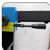
Réglage de la table d'entrée par levier excentrique
