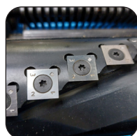
Arbre hélicoïdal à plaquettes carbure standards
