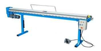
Les baguetteuses permettent d'ourler des feuilles de métal sur des diamètres de 13 à 25mm.
