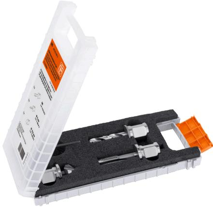
Contenu : resp. 1 x taraud M6 selon DIN 352/ISO 13 avec adaptateur Weldon 3/4 in, 1 x foret hélicoïdal HSS Ø 5 mm avec porte-outil Weldon 3/4 in et 1 x embout de chanfreinage HSS 90° Ø 16,5 mm avec adaptateur Weldon 3/4 in, ainsi que 1 clé Allen dans un coffret de rangement en plastique pratique.
