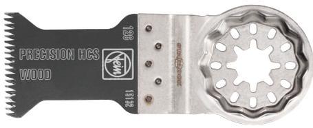
Denture japonaise double pour tous les matériaux dérivés du bois, les plaques de plâtre et les plastiques souples. Vitesse de travail extrêmement élevée et précision optimale. Forme étroite, taillée pour une vitesse de coupe optimale et une bonne évacuation des copeaux.
