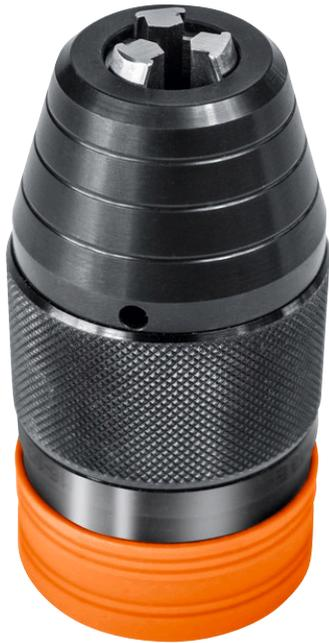
Mandrin de perçage en métal à resserrage automatique de la marque Röhm avec mors de serrage plats. Empêche les forets hélicoïdaux et les tarauds de patiner. Plage de serrage 1,5 à 13 mm. Travail précis grâce à une grande précision de coaxialité jusqu'à 0,35 mm. Compatible avec toutes les visseuses sans fil FEIN avec interface QuickIN/QuickIN MAX.
