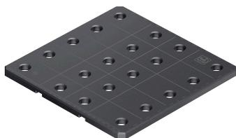
Plaque de soudage durable avec un diamètre de perçage de 16 mm sur 250 x 250 mm. Haute protection de la surface grâce à la plasmatisation et avec un gabarit de perçage préfabriqué pour les éléments Demmeler et Siegmund. Grâce à un système modulaire unique, maintien sûr dans différentes situations de travail. Compatible uniquement avec l'aimant permanent FEIN VersaMAG (32172050020).
