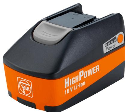
Batterie lithium-ion HighPower munie de cellules puissantes, d'un témoin de charge et de la FEIN SafetyCell Technology. Courant de sortie élevé sur la durée, avec une intensité 75 % plus élevée qu'une batterie lithium-ion. Recommandée pour les unités de perçage magnétiques sans fil et les meuleuses d'angle sans fil FEIN. Peut être utilisée sur toutes les machines sans fil 18 V FEIN.
