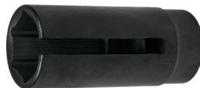
**Utilisation :** Opel Corsa B, Volkswagen-Modèles >2006, etc.**Code EAN** 4042146210987**Description de l'image** B**Entraînement en pouces** 1/2 "**Longueur totale en mm** 90,0 mm**Norme** DIN 3120, ISO 1174**Taille du profil en mm** 29,0 mm**Poids** 500 g
