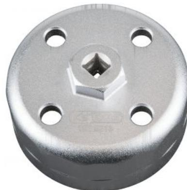
**6 pans extérieur en mm** 21,0**Carré d'entraînement en pouce** 3/8"**Code EAN** 4042146392188**Diamètre en mm** 88,8 mm**Forme** En forme de tasse**Matière** Acier**Nombre de crans** 15**Nombre d'étages** 1**Norme** DIN 3120, ISO 1174**Utilisation (marque)** Hyundai, Kia**Poids** 289 g
