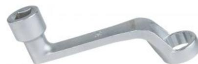
**Utilisation :** Audi, Seat, Skoda, Volkswagen**12 pans en mm** 24,0 mm**Carré d'entraînement en pouce** 1/2"**Code EAN** 4042146676752**Longueur totale en mm** 136,0 mm**Matière** Acier Chrome Vanadium extra-fin**Norme** DIN 3120, ISO 1174**Profil 1** 12 pans**Utilisation (marque)** VAG**Poids** 320 g
