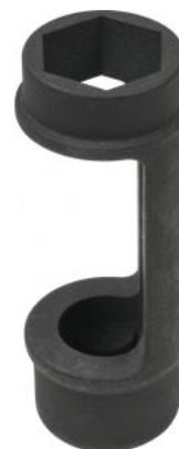
**6 pans en mm** 22,0 mm**Carré d'entraînement en pouce** 1/2"**Code EAN** 4042146603451**Longueur totale en mm** 90,0 mm**Matière** Acier Chrome Vanadium extra-fin**Norme** DIN 3120, ISO 1174**Profil 1** 6 pans**Utilisation (marque)** Audi / VW**Poids** 206 g
