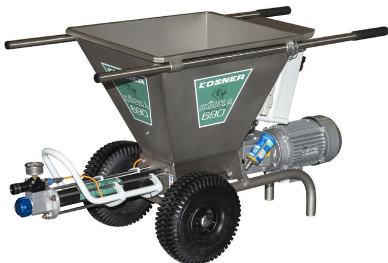
La Kobra 690 airless permet d'appliquer tout type d'enduit pelliculaire prêts à l'emploi. C'est une machine compacte, silencieuse et légère qui passe partout.
