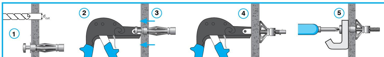
**1** Percer le support au diamètre "d<sub>cut</sub>" indiqué.
