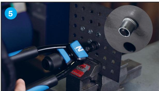
5 Sertissage de l'écrou: Insérer l'écrou dans le trou de perçage de la plaque perforée. Refermer les bras de la pince pour sertir l'écrou.
