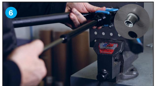
6 Retirer l'outil : Ouvrir les bras Tirer sur la tige de dévissage rapide pour retirer l'outil N300-T
