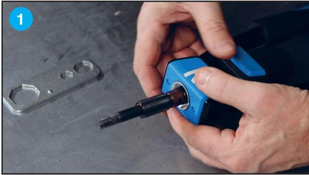
1 Sélectionnez le tirant et le nez correspondants au diamètre de l'écrou à sertir à poser (M4, M5, M6, M8 ou M10) et les monter sur l'outil
