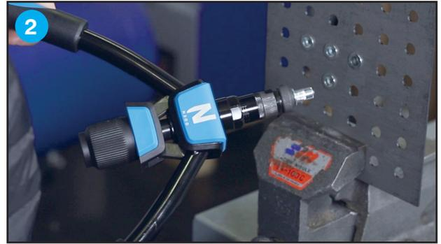
2 Ecartez entièrement les bras de N300 et monter l'écrou à sertir sur le tirant, jusqu'en butée du nez
