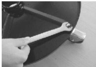
Placer les écrous (6), les rondelles (7) et (8) sur les roues (10), serrer les en utilisant le clé 14 mm fournie.
