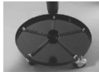
insérer l'extrémité large du vérin pneumatique (5) dans le plateau d'outil (9)
