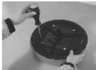
fixer le siège (1) et le contrôle descente (2) à l'aide des rondelles (3) et vis (4), les fixer avec un tournevis cruciforme.
