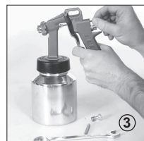
③ Appuyer sur la gâchette afin de retirer l'aiguille.
