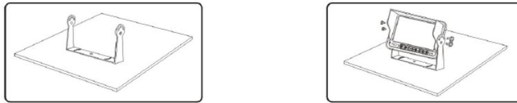
Installer le moniteur sur le support en U à l'aide des vis de serrage inférieures, ajuster l'angle puis placer les vis de serrages supérieures. Vous pouvez ajuster l'angle jusqu'à 30° vers l'avant et vers l'arrière.
