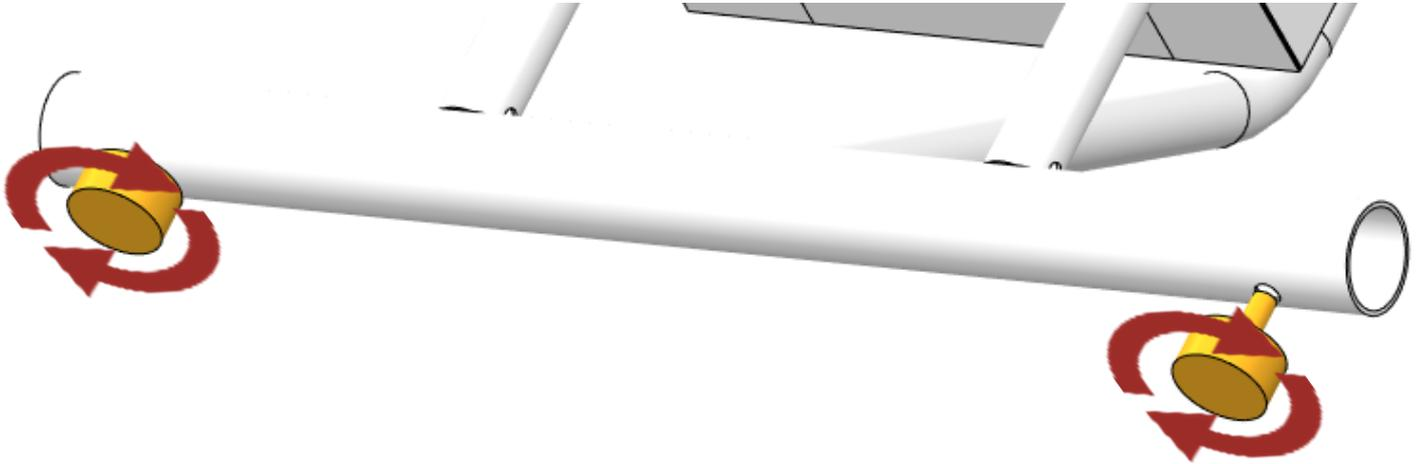
L'ensemble roulette se monte sur le treuil en dévissant les butées en caoutchouc de l'embase et se fixe grâce à des goupilles.
