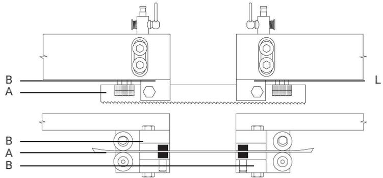
Le réglage des roulements et des guides ruban influe principalement sur la durée de vie du ruban et la qualité de la coupe.
