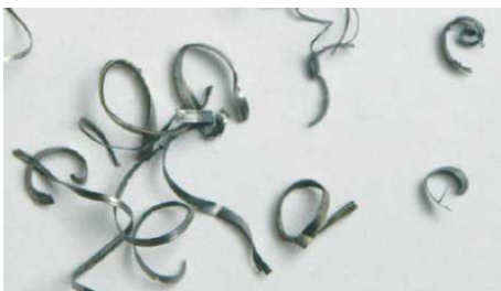
Des copeaux très fins ou poudreux indiquent une avance insuffisante
