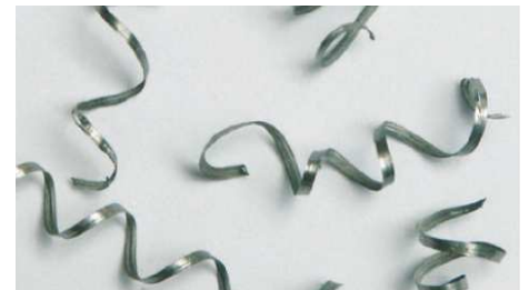
L'enroulement modéré des copeaux indique des conditions de coupe correctes
