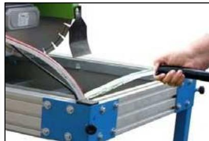
Pendant les opérations de coupe, beaucoup d'impuretés s'accumule dans le fond du bac. Il faut alors fréquemment changer l'eau dans le but de garantir le bon fonctionnement de la pompe et un refroidissement optimal du disque. Le bac est doté d'un bouchon de vidange qui facilite cette tâche.
