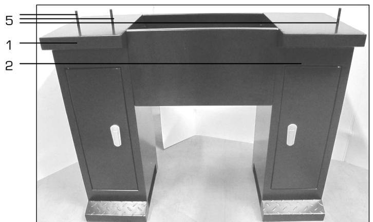
7. Placer correctement le plateau (6) sur les deux colonnes (1 et 2).
