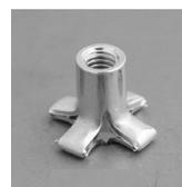
L'écrou étoilé multiserrage « UCD » est un écrou à sertir à fût fendu formant 4 pétales lors du sertissage sur une surface plane, créant ainsi une large surface d'appui à l'arrière de celle-ci.
