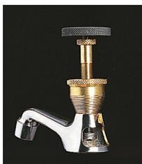
Appareil à fraiser les sièges de robinets. Ressort pour maintenir la fraise au contact du siège de robinet. Fraise taillée en bout, vissée sur le porte-fraise. Taraudage M7. Cône assurant l'adaptation sur la tête du robinet.
