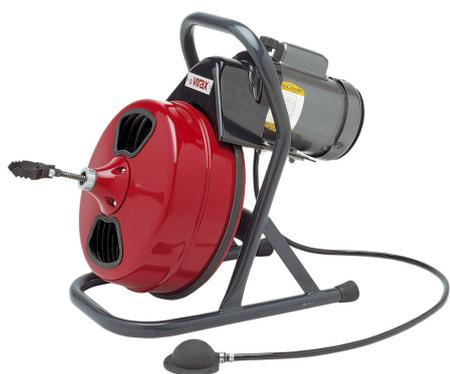
**Indispensable pour tout débouchage sur canalisation Ø 30 mm à 100 mm. Efficace grâce à son câble à âme acier de 22,5 m, pour un rapport résistance/flexibilité optimal. Motorisation puissante, réversible droite/gauche jusqu'à 165 trs/min.**
