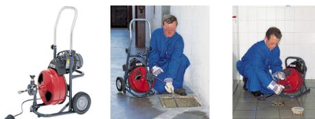
Rotation électrique avec pédale pneumatique.
