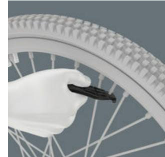
Les démonte-pneus en plastique renforcé de fibre de verre permettent de retirer les pneus de la jante, sans endommager la jante. Avec un des démonte-pneus, faire levier avec la jante et l'accrocher dans un rayon et détacher le pneu avec le deuxième démonte-pneu. Pour éviter qu'ils ne se perdent, les deux démonte-pneus se fixent l'un dans l'autre.
