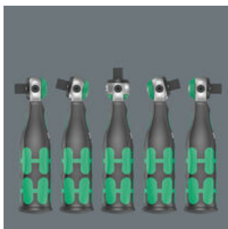
La tête du cliquet est librement orientable et peut être déverrouillée en toute position grâce au bouton coulissant positionné sur les 2 côtés. Travail sans problème et avec une grande liberté de manœuvre, même dans les endroits très exigus ou difficiles d'accès. Les positions de blocage définies à 0°, 15° et 90° à gauche et à droite garantissent un travail sûr et empêchent la tête de riper.
