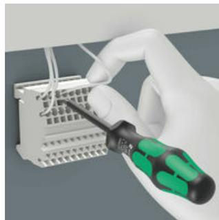
La pointe de la lame reste dans le bornier, ce qui laisse les deux mains libres pour engager l'extrémité du fil.
