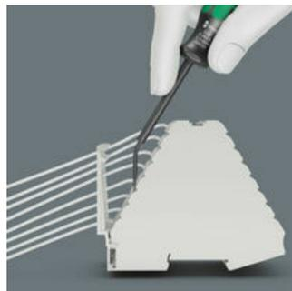
Les borniers retiennent les extrémités des fils mécaniquement. Sur les borniers à ressort, la force nécessaire est appliquée grâce à un ressort. Le ressort doit être ouvert à l'aide d'un outil pour pouvoir insérer les extrémités des fils. Les actionneurs spéciaux de Wera permettent d'actionner les borniers, même dans les recoins exigus des tableaux de distribution. Grâce à la lame courbée, il est possible d'atteindre les borniers à ressort là où les outils à lame droite sont inefficaces.
