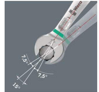
L'angle de 7,5° de la fourche, la géométrie 12 pans et l'ajustement de l'utilisation (positionner, visser, tourner, positionner, visser, tourner, etc.) permettent de visser même dans des situations où l'angle de reprise est inférieur à 30°.
