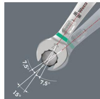
Le coudage à 7,5°, la forme dodécagonale et un geste adapté (positionner, visser, tourner, positionner, visser, tourner, etc.) permettent de résoudre des situations de vissage où l'angle de reprise ne peut pas excéder 30°.
