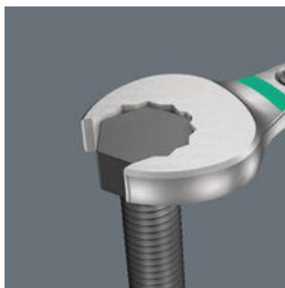
La géométrie 12 pans de la fourche de la clé Joker 6005 assure un ajustement parfait avec la tête de vis ou l'écrou, ce qui diminue le risque de dérapage.
