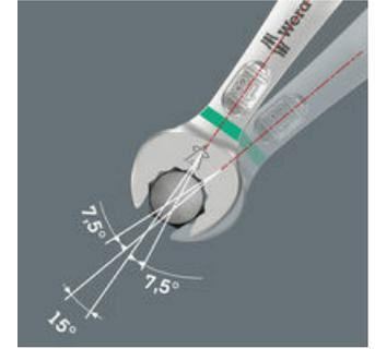
Le coudage à 7,5°, la forme dodécagonale et un geste adapté (positionner, visser, tourner, positionner, visser, tourner, etc.) permettent de résoudre des situations de vissage où l'angle de reprise ne peut pas excéder 30°.
