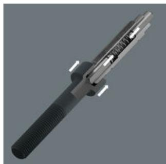
L'embout 4-en-1 9506 permet d'utiliser quatre tailles de vis à six pans creux (3,0 ; 4,0 ; 5,0 ; 6,0). Pour utiliser le profil supérieur, il faut appuyer en continu contre le ressort en vissant, de manière à enfoncer le profil plus petit.
