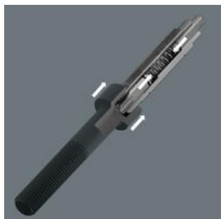
L'embout 4-en-1 9507 permet d'utiliser trois tailles de vis à six pans creux (2,5 ; 5,0 ; 6,0) et une taille de vis TORX® (TX 25). Pour utiliser le profil supérieur, il faut appuyer en continu contre le ressort en vissant, de manière à enfoncez le profil plus petit.
